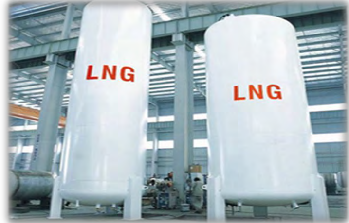
LNG Holding Tank
